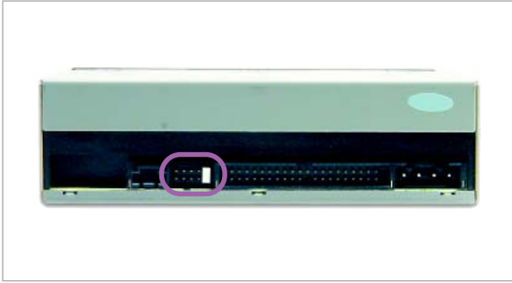
圖 2-53 Jumper 設定 IDE 介面裝置之 Jumper 設定
