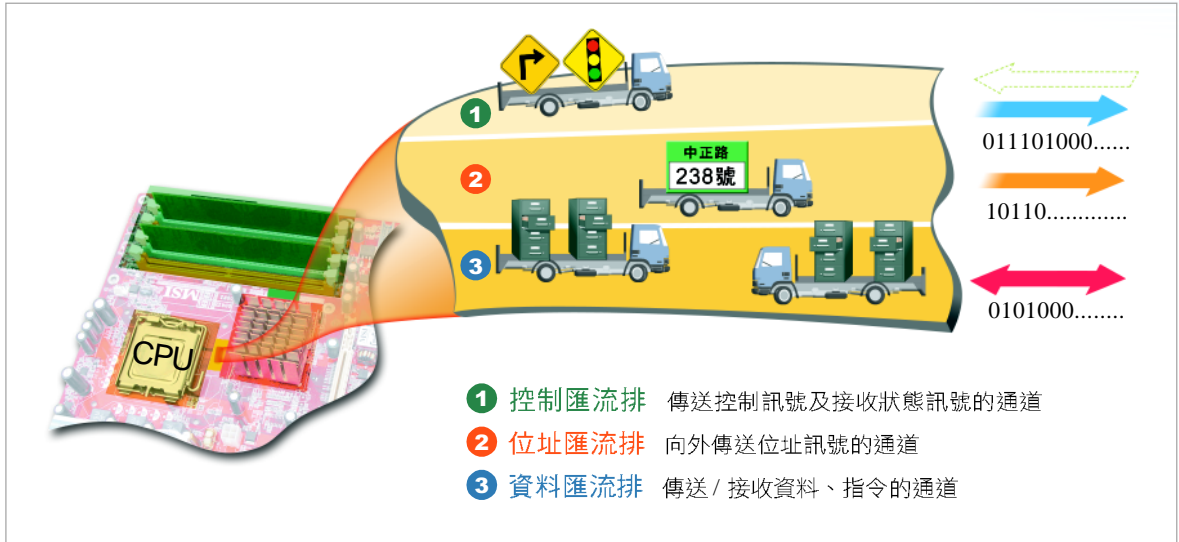
圖 2-3 匯流排示意圖 匯流排是傳遞一串（0 或 1）電子訊號的通道；在這 3 種匯流排中，只有資料匯流排是可雙向傳輸資料
