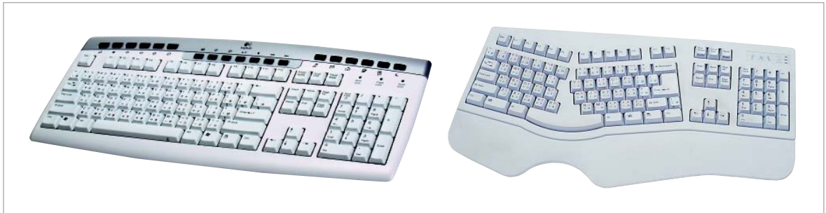
圖 2-24 鍵盤 依照設計的樣式，可分為傳統鍵盤 (左)；人體工學鍵盤 (右)
