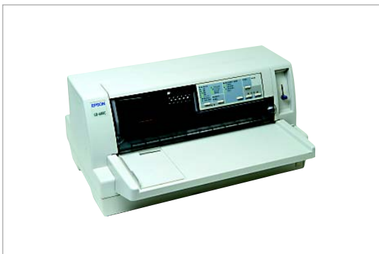
圖 2-30 點陣式印表機 列印時，會發出較大的撞擊聲響
