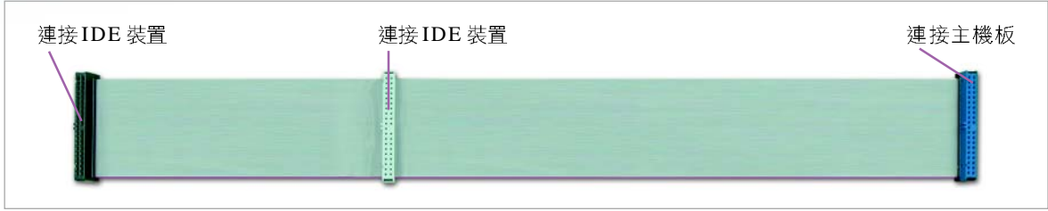
圖 2-52 IDE 排線 同一條 IDE 排線可連接兩個 IDE 裝置
