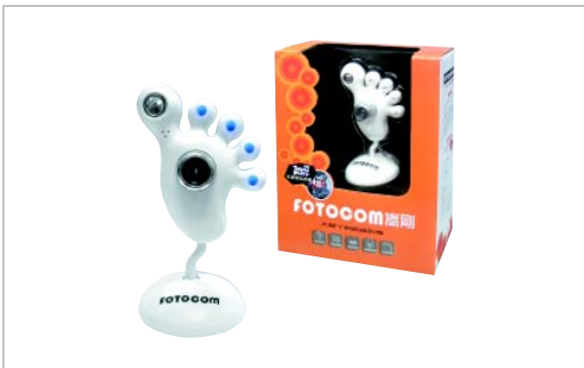
圖 2-37 PC 視訊攝影機 擷取動態視訊影像的設備
