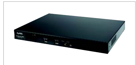
圖 4-27 無線閘道器 用來連接不同類型的網路
