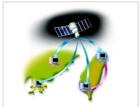
圖 4-14 廣域網路示意圖 例如大型企業連結各地區分公司的網路
