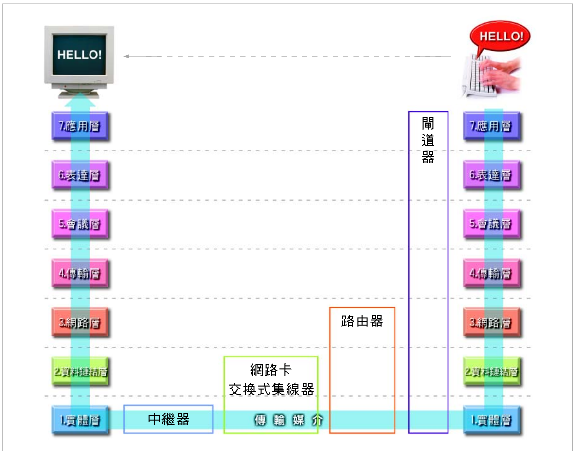
圖 4-35 OSI 七層架構及常見硬體設備對照示意圖 OSI 通訊標準中，每一層皆有其負責的工作，依照軟硬體的功能可分別對應至不同的層級
